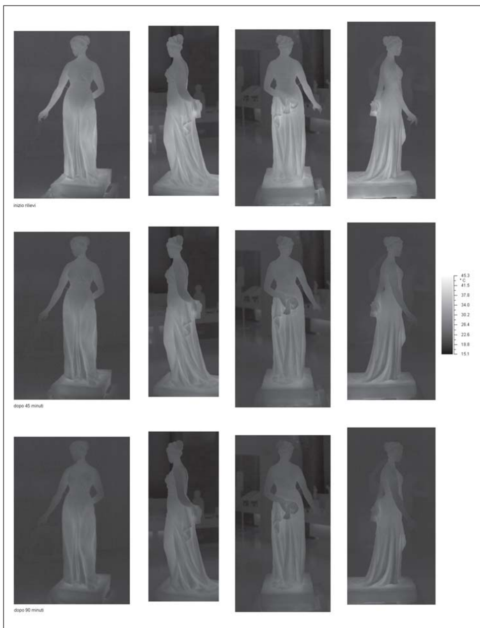
Fig. 6 - Serie di mosaicature delle riprese termiche realizzate in successione a 45 minuti una dall'altra.
