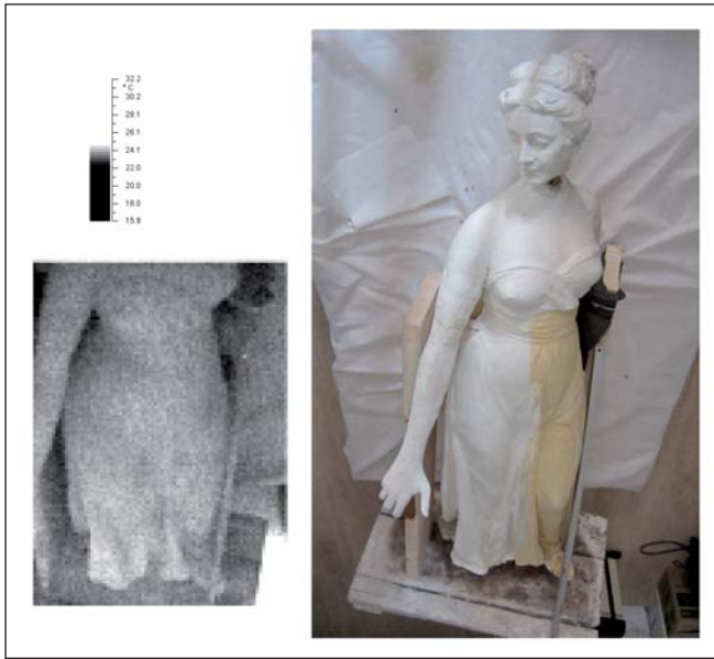
Fig. 2 - Esempio del campo di temperatura rilevato in un istante intermedio della fase di raffreddamento dell'ambiente che accoglie la statua La Greca . I saggi del campo di temperatura per ciascuna delle quattro postazioni fra loro ortogonali sono stati eseguiti con cadenza media di uno ogni 5 minuti. Per ogni acquisizione sono stati mediati i dati termografici di riprese in rapida successione per migliorare il rapporto segnale/rumore.
